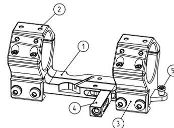
Als Sonderzubehör sind zwei unterschiedlich große Picatinnyaufsätze erhältlich, welche an acht Positionen mit der Blockmontage verschraubt werden können. Dies ermöglicht die Befestigung zusätzlicher Visiereinrichtungen.
