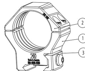
Als Sonderzubehör ist eine spezielle Rohrklemme mit integrierter Klapplibelle erhältlich auf welcher zwei unterschiedlich große Picatinnyaufsätze angebracht werden können. Dies ermöglicht die Befestigung zusätzlicher Visiereinrichtungen.
